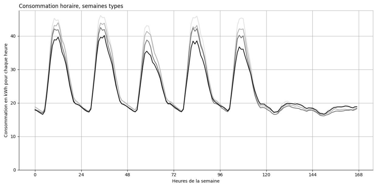
Courbe noire : pointe à 40.2 kW et ruban à 16.6 kW. Consommation totale : 4020.2 kWh.
