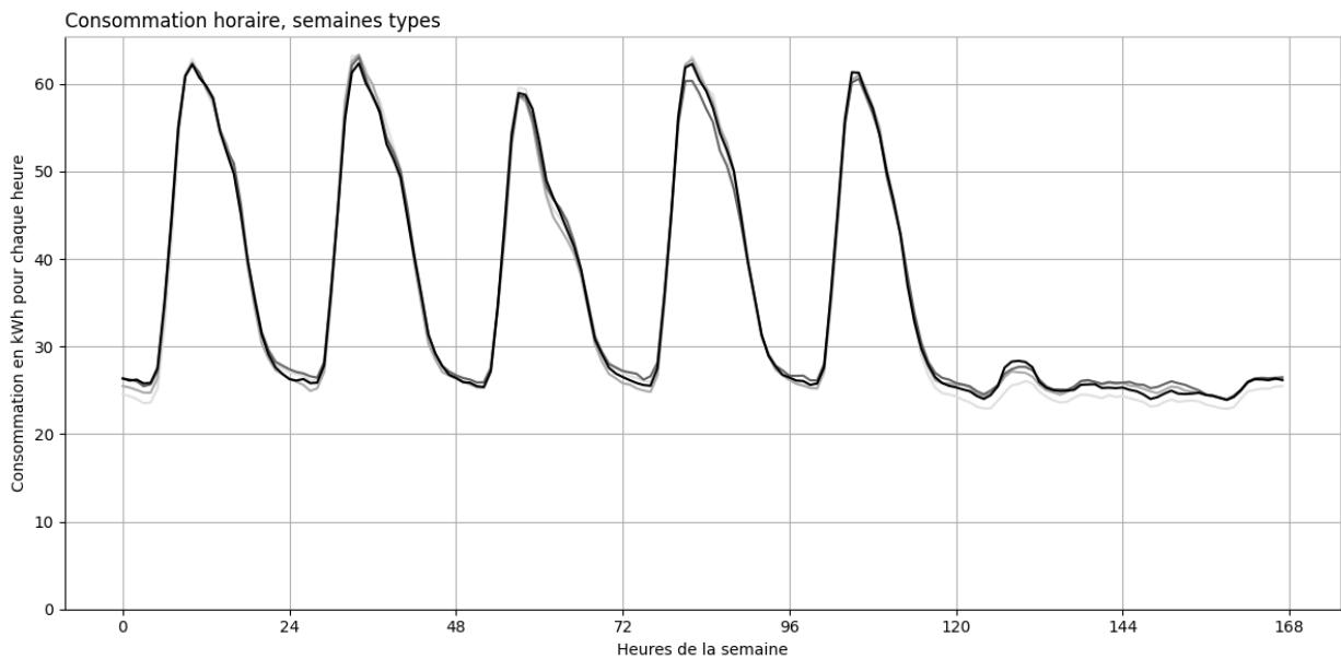
Courbe noire : pointe à 62.4 kWh et ruban à 23.9 kWh. Consommation totale : 6041.5 kWh.
